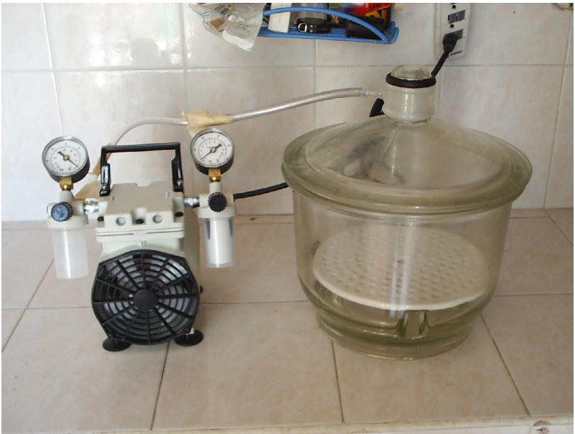
Figura 3. Bomba y cámara de vacío
